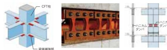
高いじん性(粘り強さ)と剛性を有するCFT柱(コンクリート充填鋼管柱)と地震時のエネルギーを吸収し、フレームの損傷を低減することが可能なハニカムダンパを採用した制震構造。耐震性能は建築基準法の1.25倍を確保。
